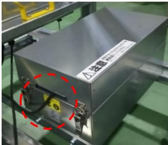
※ DXタイプなどバッテリーを2台使用する機種は2台同時に新品交換してください。
